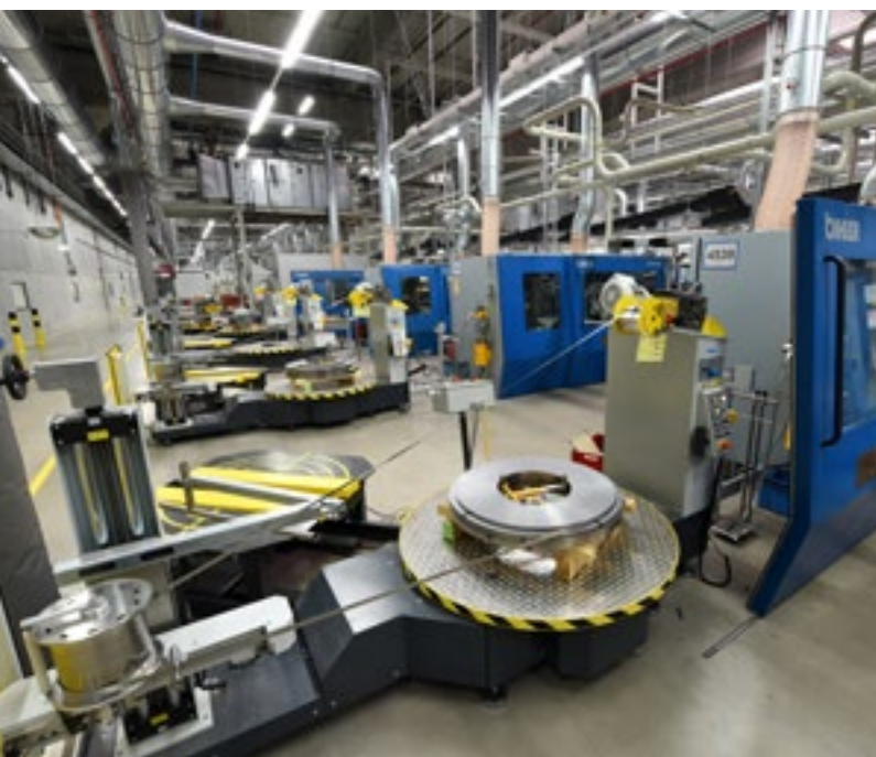
Fertigungszelle mit Biegeautomaten der Metallverarbeitung von ARaymond
